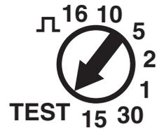
Remarque: Si le relais pour la commande de lumière n'est pas utilisé, la temporisation à l'extinction devrait être réglée à 16 min, pour éviter des commutations régulières et inutiles du contact.
