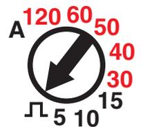
Remarque: Si le relais pour la commande des appareils n'est pas utilisé, la temporisation à l'extinction devrait être réglée à 120 min, pour éviter des commutations régulières et inutiles du contact.
