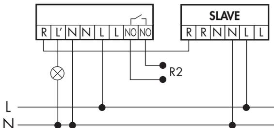
L'appareil PD2 MAX MASTER est le seul à lire les valeurs Lux et active les consommateurs. Les détecteurs de présence PD2 MAX SLAVE donnent une impulsion par le contact R, en cas de mouvement détecté indépendamment de la luminosité crépusculaire. L'appareil MASTER doit toujours être monté à l'endroit où la quantité de lumière est la plus faible.
